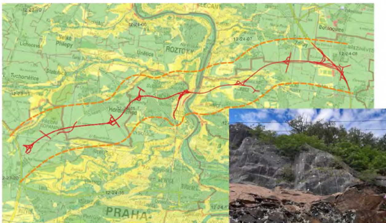
Obr. 31 Mapa náchylnosti svahů k sesouvání s fotem zachycující aktuální stabilizaci skal Vltavského kaňonu
