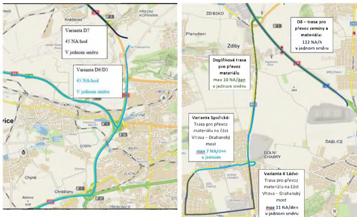
Obr. 53 Situace s vyznačením posuzovaných jednosměrných intenzit staveništní dopravy (převzato z Hlukové studie příl. B.2)
